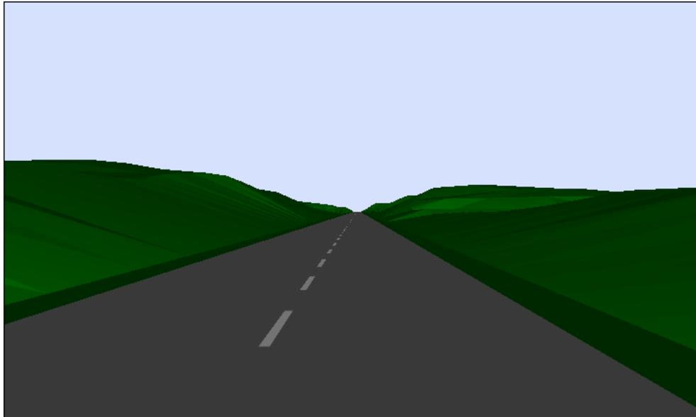
**Figura 4.4 – Talude junto de uma via, funcionando como barreira acústica.**
