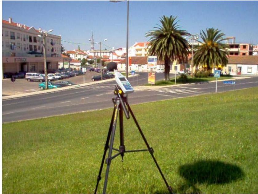
**Figura 4.1 – Exemplo de uma medição realizada com o sonómetro numa via rodoviária.**
