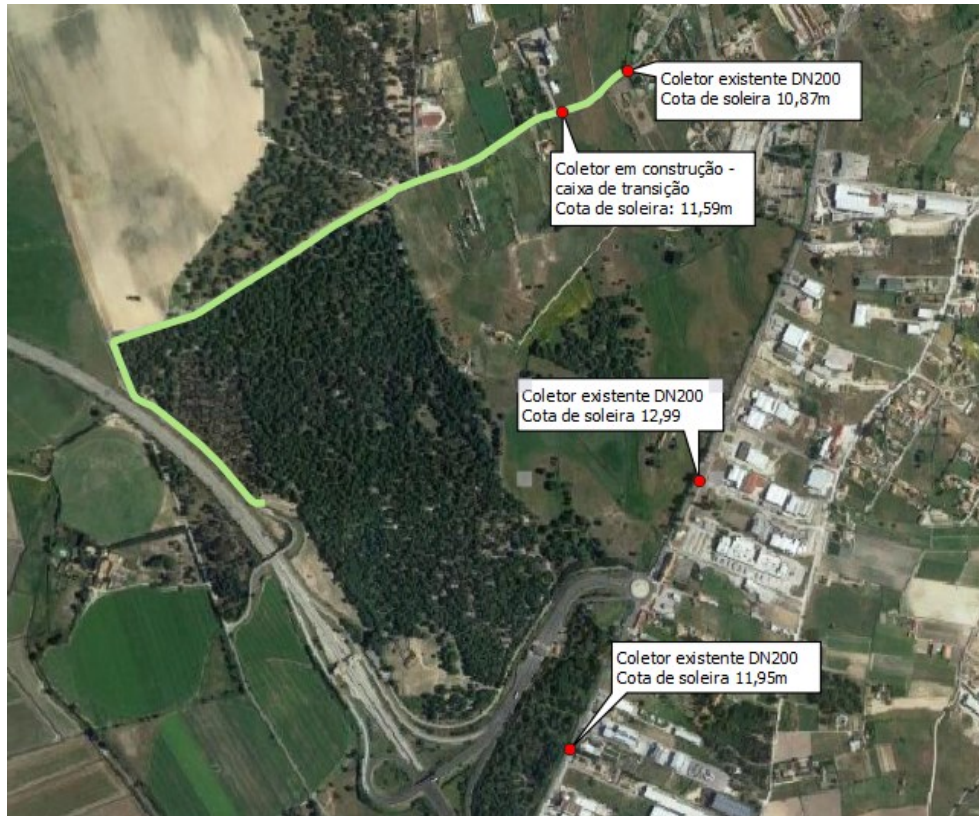
Figura 14: Infraestruturas de saneamento de águas residuais em construção a sul da UE
