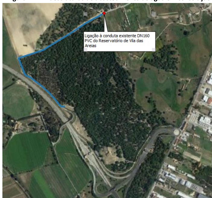
Figura 12: Infraestruturas de abastecimento de água em construção
