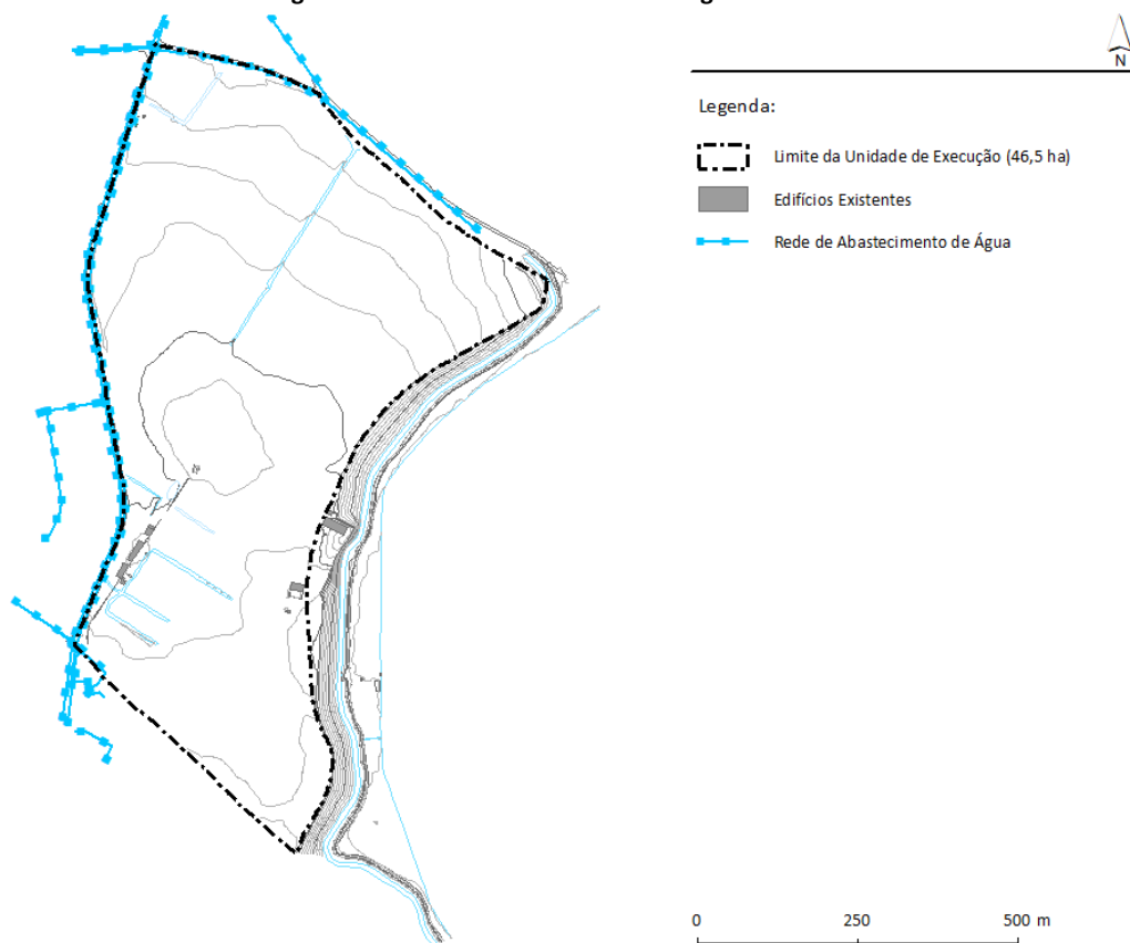
Figura 13: Rede de abastecimento de água
